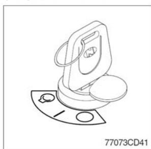
(1) Имеется три положения: OFF (Откл.), ON (Вкл.) и START (Пуск).
