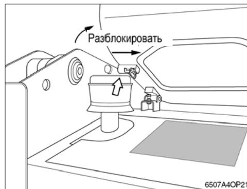
(2) Надавите на стопорный палец пневматического амортизатора.
