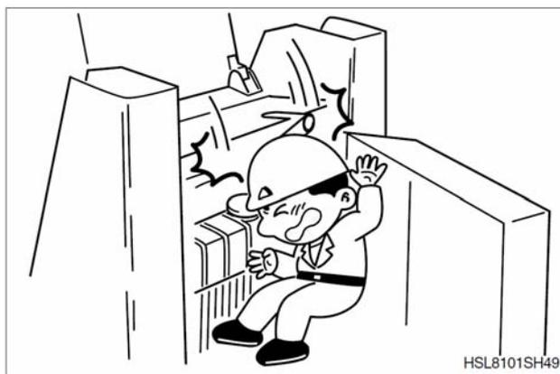
При обслуживании и проверке отсека двигателя у задней дверки и капота двигателя соблюдайте осторожность, чтобы не удариться головой.
